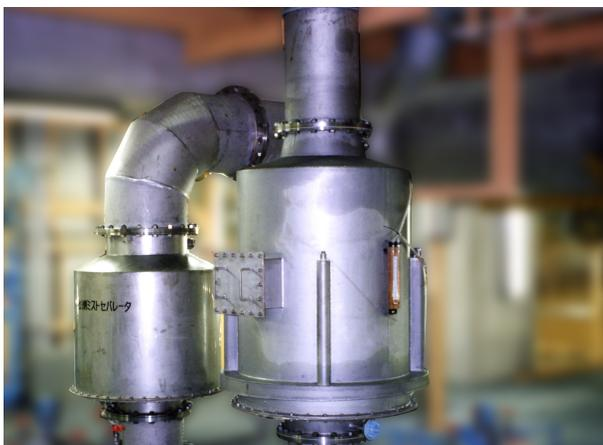
LGⅠミストセパレーターは生活排水を処理する下水処理場の汚泥焼却炉排ガス洗浄塔から排出する煤塵や無機粉塵が混入した排ガスのミストを除去して、誘引ブロワーを保護しております。これによって誘引ブロワーのインペラやケーシングには煤塵やダストの付着は無く、振動も発生しない状態で長期間連続運転を継続しております。メンテナンスフリーのLGⅠミストセパレーターは流入するミストによって自浄して汚れは認められません。不純物(煤塵、粉体等の固形物)が混入したミストであっても分離・除去して目的を達成しております
